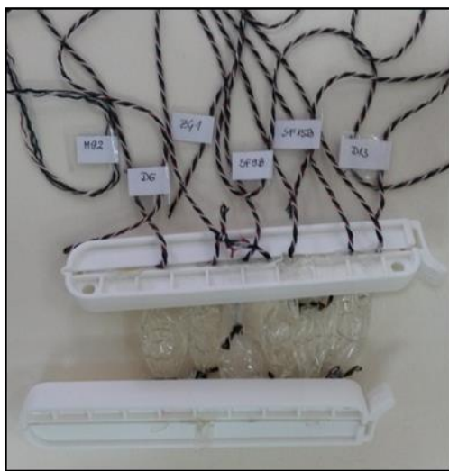
Slika 5. Prikaz pripremljenih ispitivanih uzoraka prije dijalize koji se nalaze u Spectra/Por poroznoj membrani pričvršćeni na krajevima vezicom.
