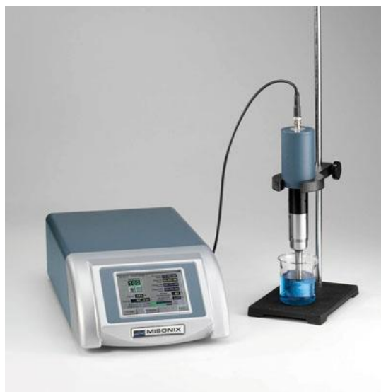
Slika 3. Uređaj za ekstrakciju potpomognutu ultrazvukom proizvođača Misonix (model Sonicator S-4000) (Anonymus 2, 2017)
