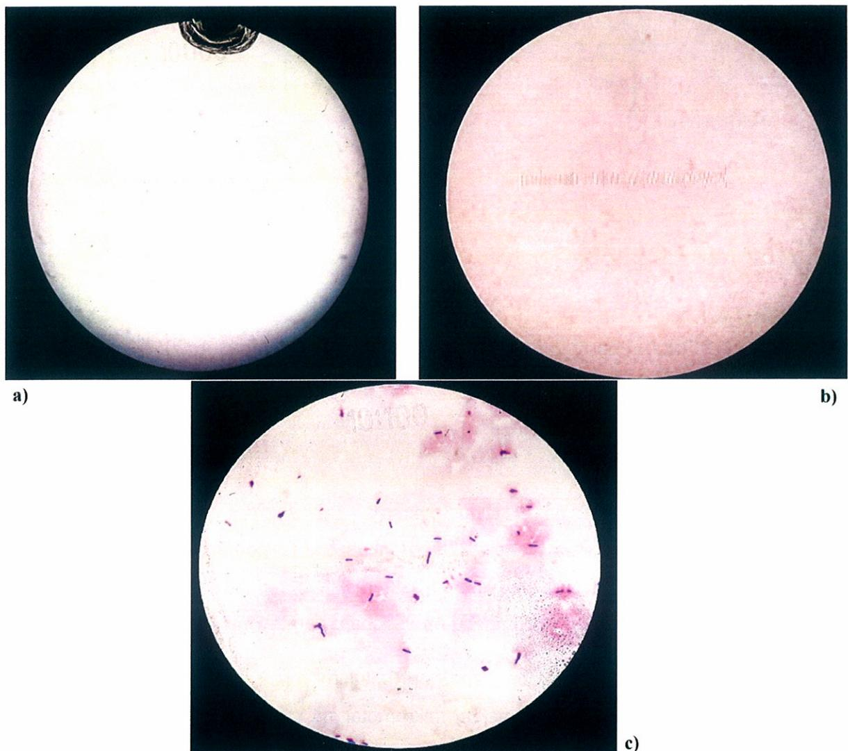
**Slika 5.** Prikaz a) okularnog mikrometra; b) objektnog mikrometra; c) mjerene veličine stanice BMK (Vlastita slika)
