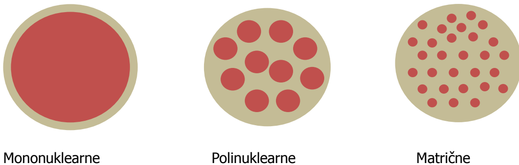
Slika 1. Podjela čestica s obzirom na morfološka svojstva (Prilagođeno iz Jyothi i sur., 2010)
