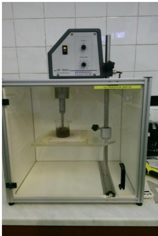
**Slika 7.** Ekstrakcija potpomognuta ultrazvukom (Vlastita fotografija, 2016)
