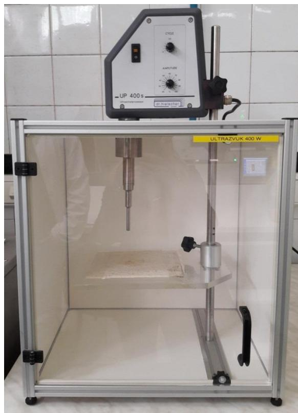
**Slika 5.** Ultrazvučna sonda (Vlastita fotografija, 2016)
