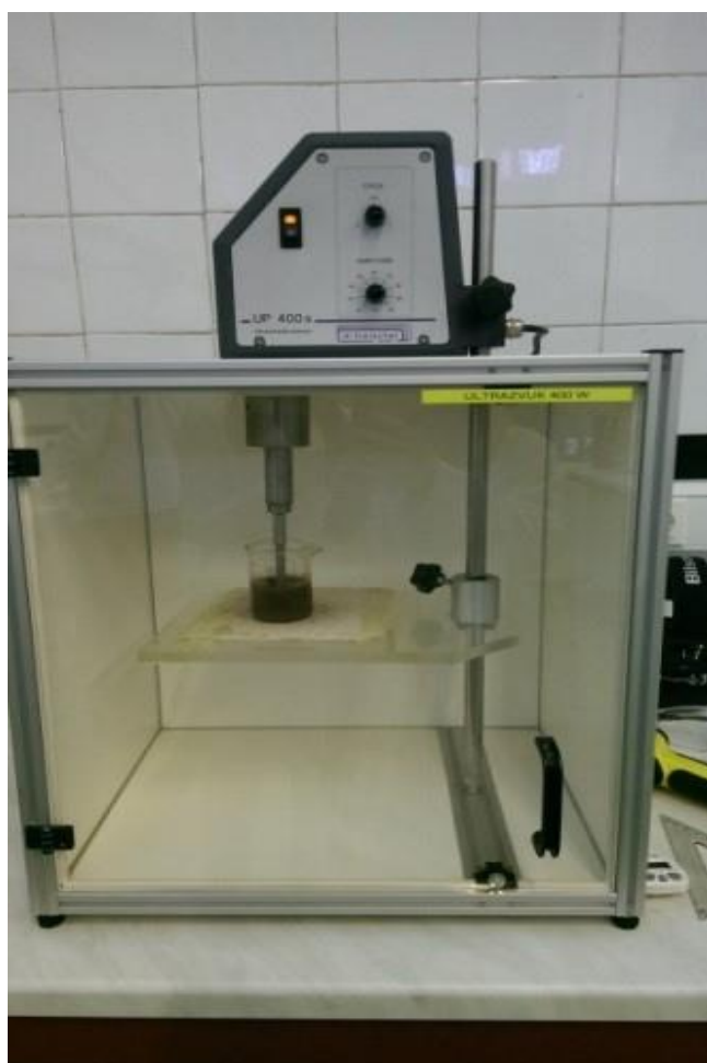
Slika 7. Ekstrakcija potpomognuta ultrazvukom (Vlastita fotografija, 2016)
