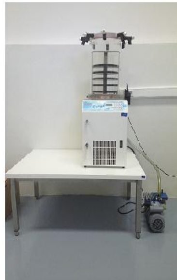
Slika 7. Shematski prikaz laboratorijskog liofilizatora.
