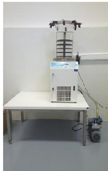
Slika 7. Shematski prikaz laboratorijskog liofilizatora.
