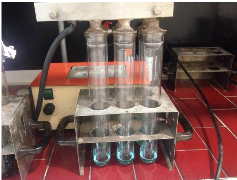
Slika 13. Blok za mokro spaljivanje uzorka kod Kjeldahl-ovog postupka (vlastita fotografija)
