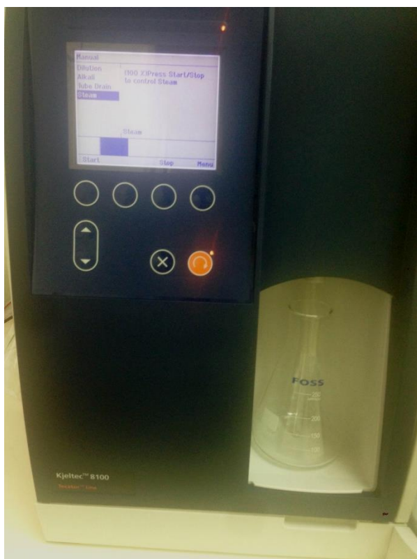
Slika 14. Kjeltec sustav za destilaciju (vlastita fotografija).
