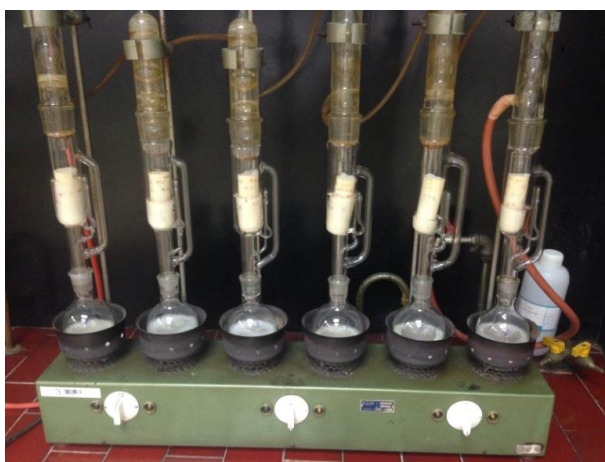
Slika 12. Aparatura po Soxhletu-u (vlastita fotografija)
