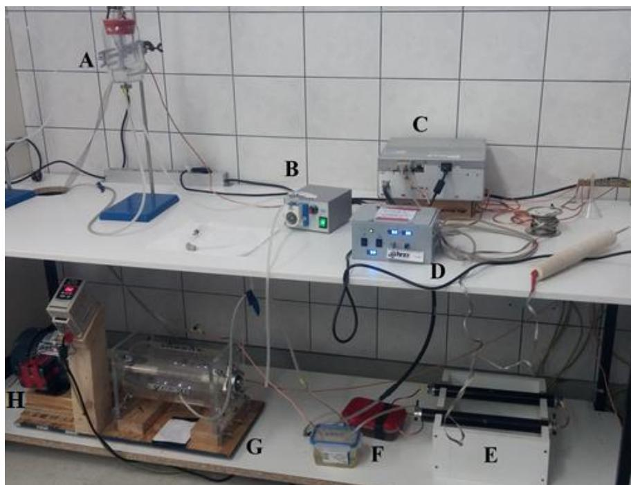
**Slika 2. Sustav za generiranje plazme u tekućini visokonaponskim pražnjnjem:** A) reaktor, B) pumpa, C) visokonaponski generator D) kontrolna jedinica za napajanje, E) otpornici  $9,5 \text{ M}\Omega$  F) kondenzator  $0,75 \text{ nF}$  G) rotirajuća sklopka, H) elektromotor s regulatorom frekvencije
