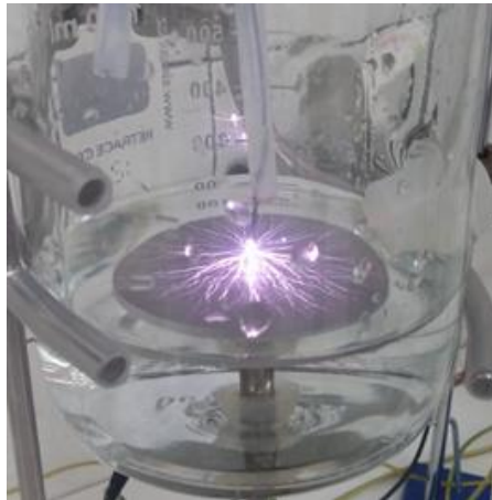
Slika 3. Tretman čiste kulture E.coli plazmom generiranom u plinskoj fazi
