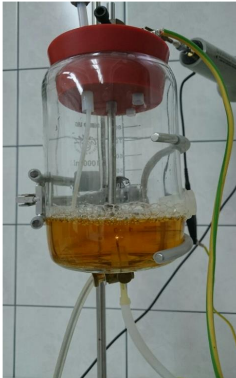
Slika 2. Tretiranje tekućinskom plazmom
