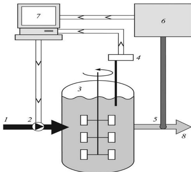
**Slika 2: KEMOSTAT** - 1. ulaz supstrata, 2. pumpe i ventili, 3. bioreaktor, 4. osjetnik, 5. uzimanje uzorka, 6. izravna kontinuirana analiza, 7. računalo, 8. Proizvod (<http://www.enciklopedija.hr/natuknica.aspx?id=31175>, 22. Svibanj 2016).
