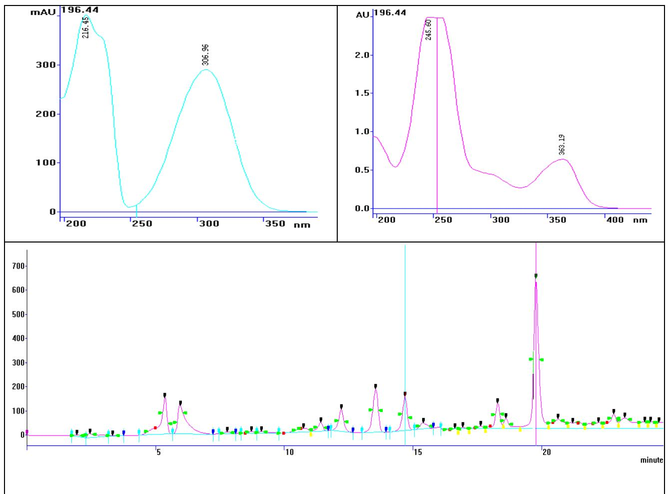
Slika 20. Kromatogram vinskog destilata odležavanog u drvenim bačvama (uzorak 6) snimljen pri 280 nm s pripadajućim spektrima (— siring aldehid, - - - elaginska kiselina).
