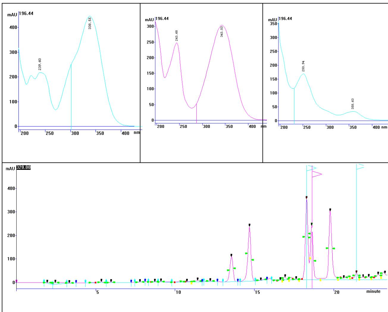
Slika 21. Kromatogram vinskog destilata odležavanog u drvenim bačvama (uzorak 6) snimljen pri 320 nm s naznačenim neidentificiranim pikovima u 17,9 (---) i 18,3 minuti (--- predpostavka - koniferil aldehid) te u 22,8 minuti (--- derivat elaginske kiseline).
