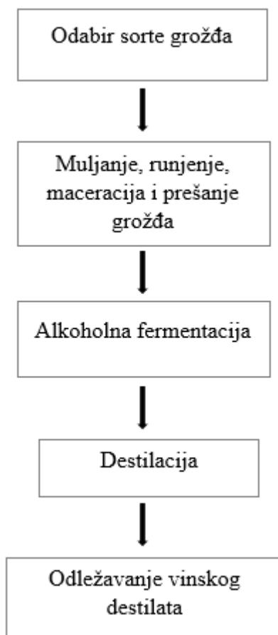
Slika 1. Tehnološka shema proizvodnje vinskih destilata (vlastita shema).
