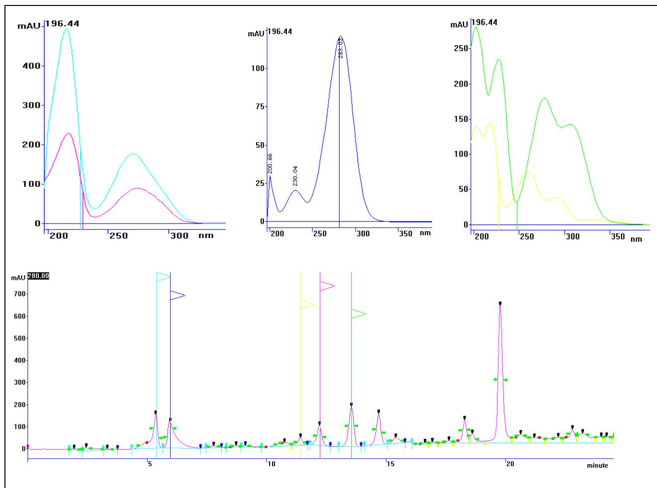
Slika 19. Kromatogram vinskog destilata odležavanog u drvenim bačvama (uzorak 6) snimljen pri 280 nm s pripadajućim spektrima (— galna kiselina, -·- siringinska kiselina, -·--- karamel, -·---vanilinska kiselina, -·--- vanilin).
