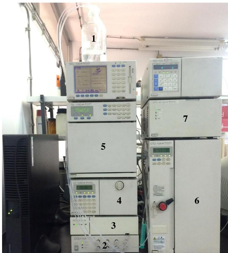
**Slika 8.** Kromatograf Shimadzu CLASS-VP LC-10A<sub>VP</sub> (Shimadzu; Kyoto, Japan). 1 - boca za pokretnu fazu; 2 - otplinjač; 3 - podjedinica za formiranje gradijenta; 4 - pumpa; 5 - auto-injektor; 6 - pećnica s predkolonom i kolonom; 7- detektor.
