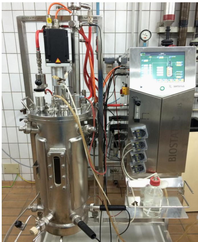
Slika 5. Laboratorijski bioreaktor s miješalom i mjerno-kontrolnom digitalnom jedinicom Biostat Cplus (Sartorius BBI Systems GmbH, Goettingen, Germany).
