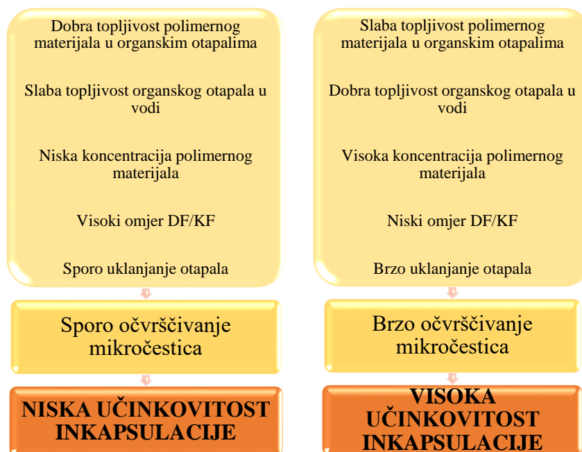
Slika 4. Mehanizam djelovanja različitih čimbenika na inkapsulacijsku učinkovitost aktivne tvari unutar mikročestica (Yeo i Park, 2004)
