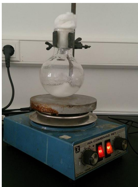
Slika 7. Aparatura za sintezu eutektičnog otapala (vlastita fotografija)
