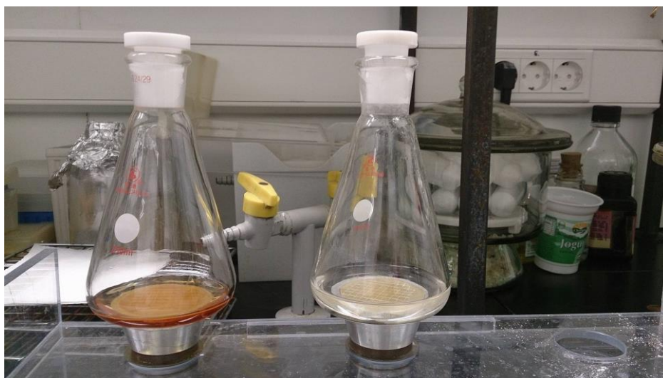
Slika 12. Usporedba eutektičnog otapala kojemu je priprava trajala više od 30 min (lijevo) i 25 min (desno) (vlastita fotografija)
