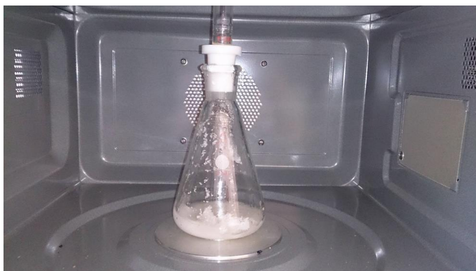
Slika 8. Tikvica u kojoj se nalazi smjesa za priprava eutektičnog otapala (vlastita fotografija)
