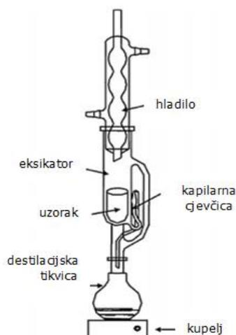
Slika 8. Aparatura za ekstrakciju po Soxhletu [16]
