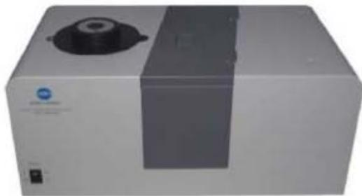
Slika 9. CM- 3500d kolorimetar (Konica-Minolta, Japan)
