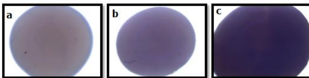
Slika 6. Mikroskopska slika hidrogel čestica s inkapsuliranim ekstraktom ružmarina pripremljenih s 5%-tnim alginatom (a-c): a-alginat (čisti); b-alginat i izolati proteina sirutke; c-alginat i zelena kava
