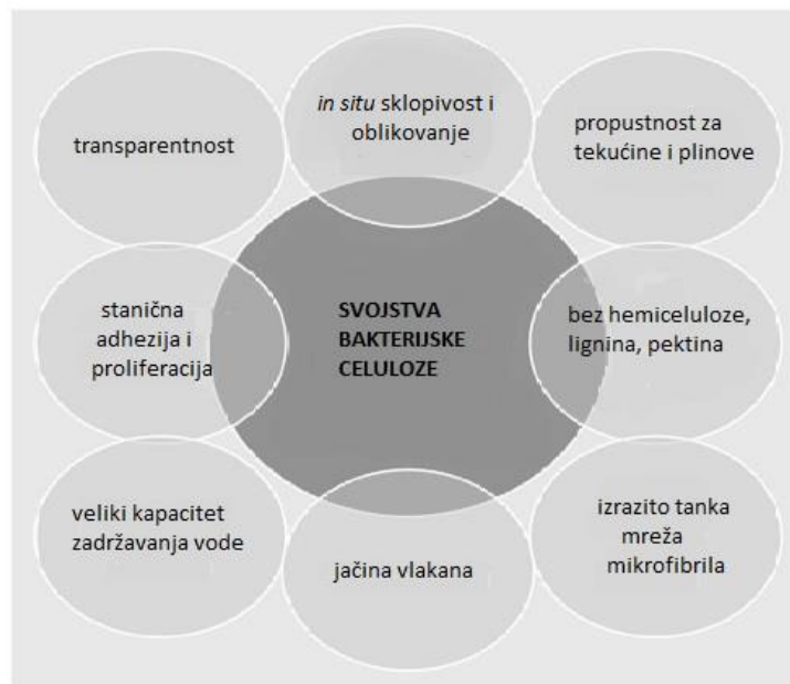
Slika 4. Strukturna svojstva bakterijske celuloze (Ullah i sur., 2014)
