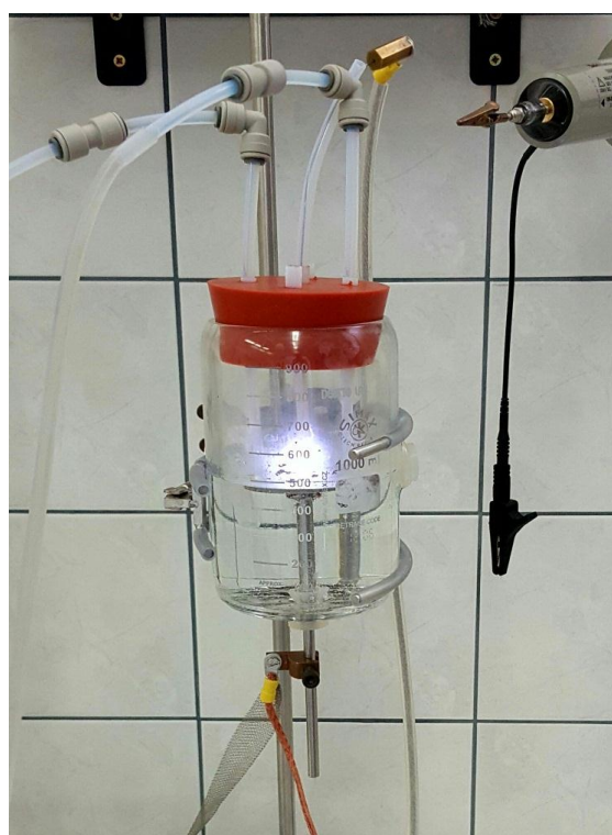
Slika 6. Reaktor s plinskim izvorom plazme (vlastita slika)
