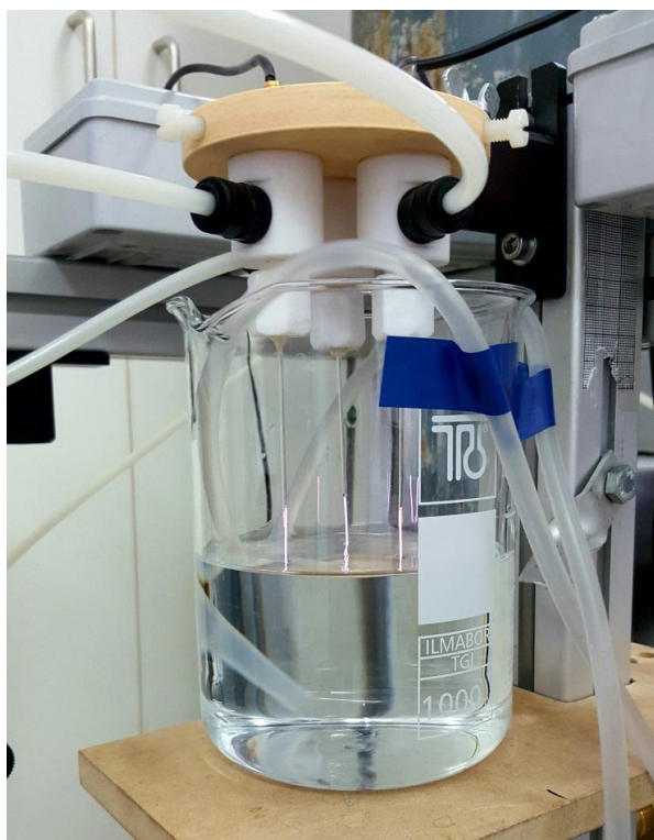
Slika 8. Reaktor s JET izvorom plazme (vlastita slika)
