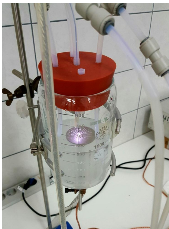
Slika 7. Reaktor s plinskim izvorom plazme uz uvođenje argona u međuprostor (vlastita slika)
