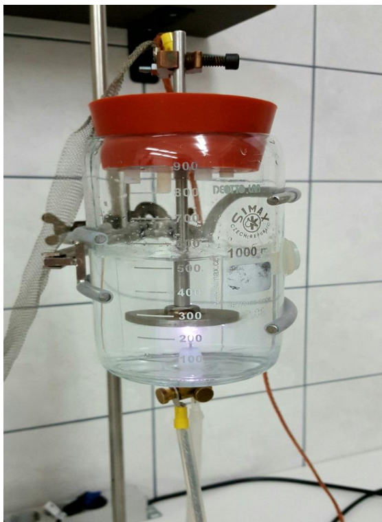
Slika 5. Reaktor s tekućinskim izvorom plazme (vlastita slika)
