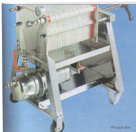
Slika 3. Pločasti filtar i princip rada (Zoričić, 1996, a).
