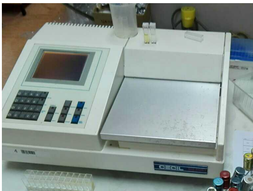
Slika 10. Spektrofotometar na kojem su provedena mjerenja utjecaja inhibitora na rast u tekućem mediju.
