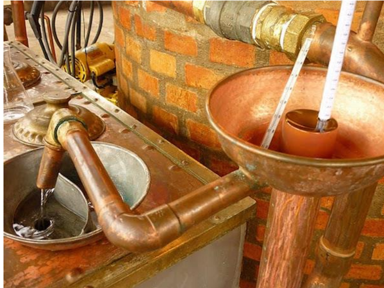
Slika 5 Mjerenje sadržaja alkohola
