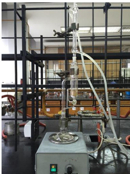
Slika 7. Aparatura za ekstrakciju po Soxhletu
