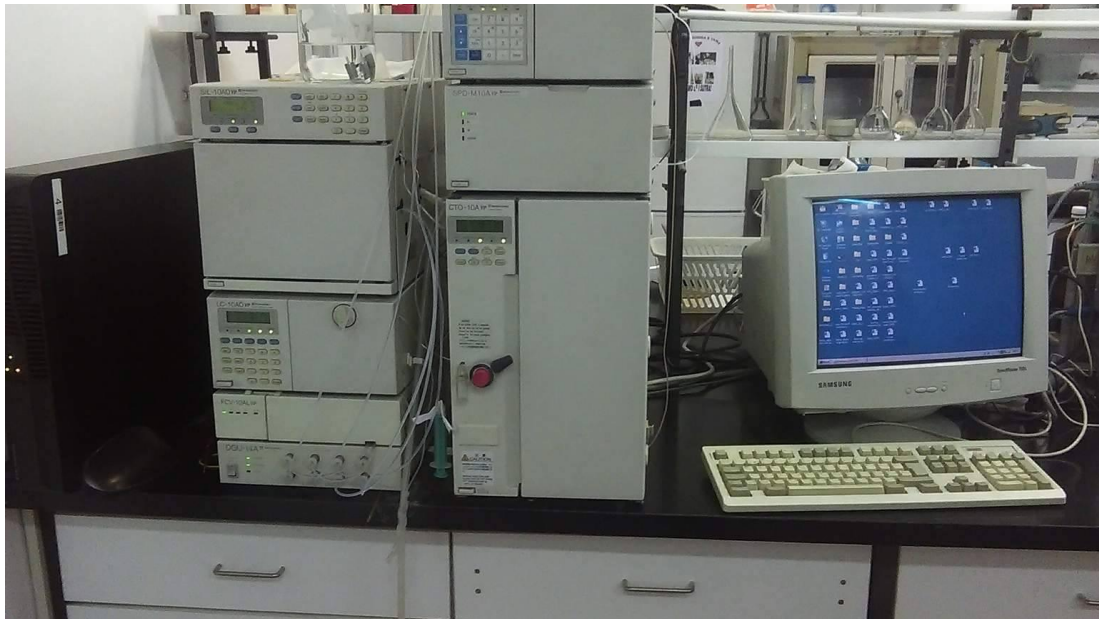
Slika 11. Shimadzu CLASS-VP LC-10A VP sustav za kromatografiju (Shimadzu, Japan, vlastita fotografija)
