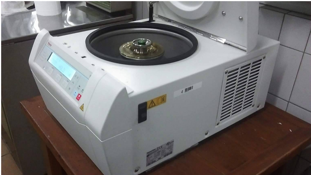
Slika 10. Centrifuga Thermo Scientific SL 8R (Thermo Fisher Scientific, SAD, vlastita fotografija)
