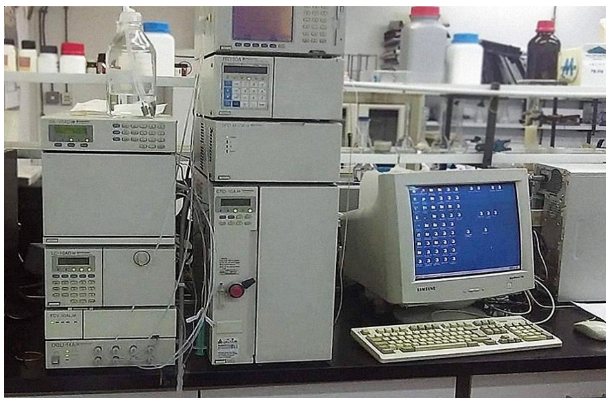
Slika 6. Uređaj za tekućinsku kromatografiju visoke djelotvornosti Shimadzu CLASS-VP LC-10A VP (vlastita fotografija)
