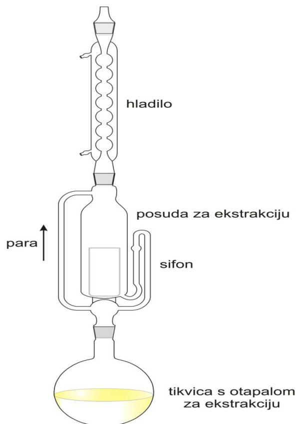
Slika 4. Shematski prikaz aparature po Soxhletu [14]
