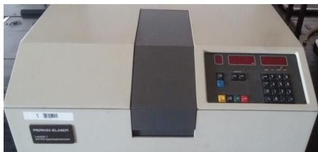
**Slika 5.** UV/Vis spektrofotometar (vlastita fotografija).
