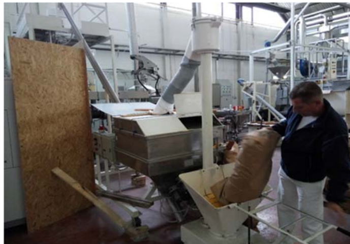
Slika 3. Unos kukuruzne krupice i doziranje u ekstruder (vlastita slika)
