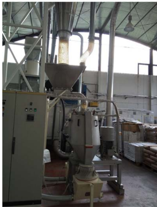
Slika 5. Mljevenje ekspanzirane kukuruzne krupice (vlastita slika)
