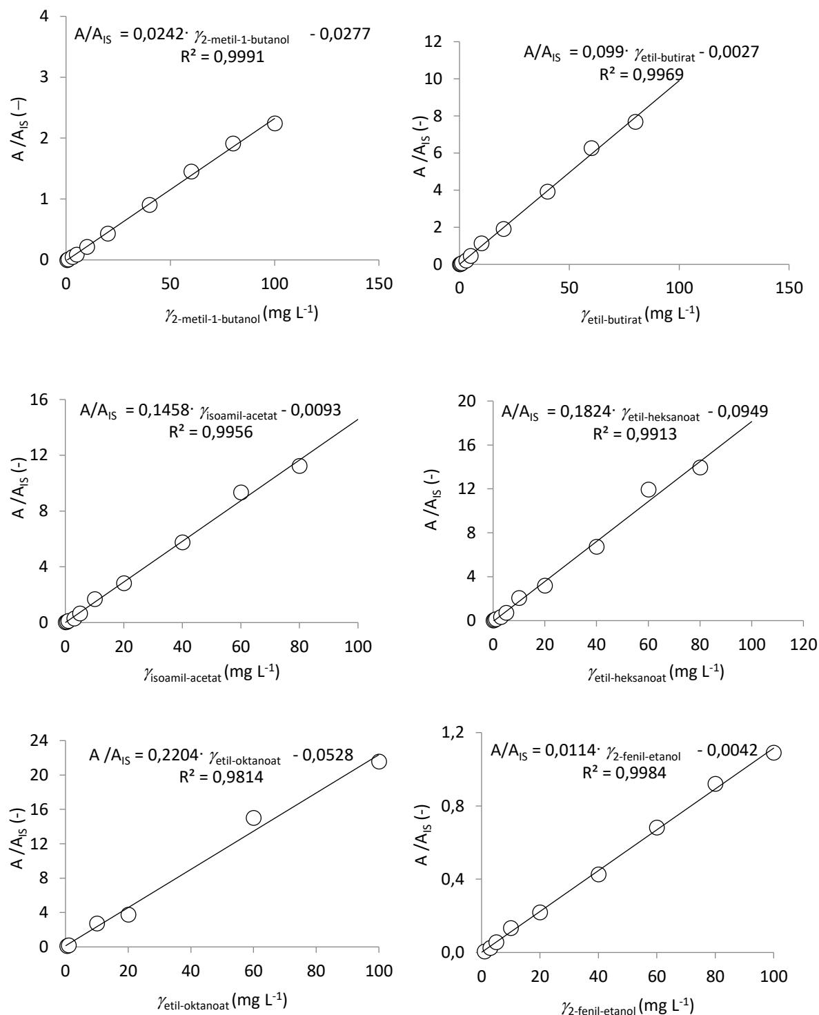
**Slika 14.b** Baždarni pravci za određivanje hlapivih komponenti piva HS-GC-FID metodom
