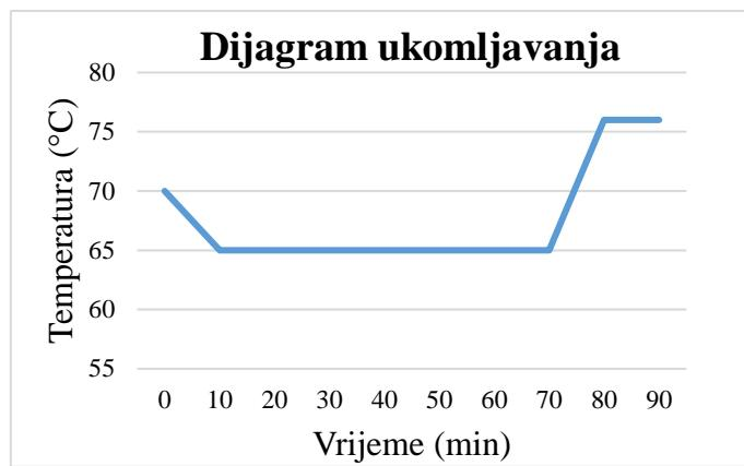
**Slika 7.** Proces ukomljavanja tijekom proizvodnje ale piva
