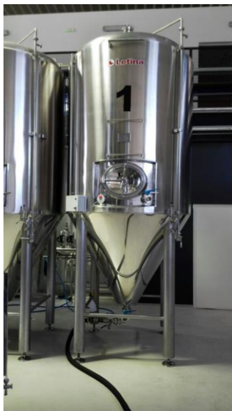
Slika 6. CKF (4000 L), Zmajska pivovara d.o.o.
