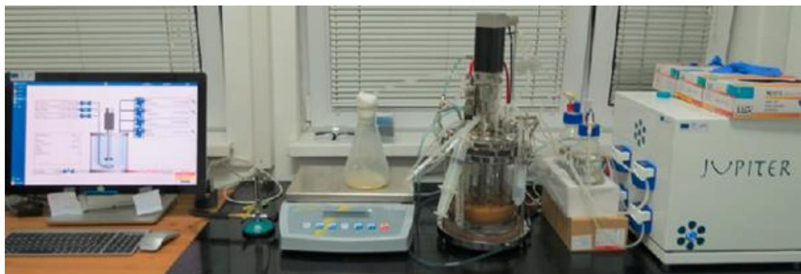
**Slika 12.** Laboratorijski sustav za vođenje procesa fermentacije u bioreaktoru
