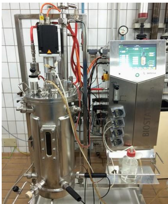
Slika 4. Laboratorijski bioreaktor s miješalom i mjerno-kontrolnom digitalnom jedinicom Biostat Cplus (Sartorius BBI Systems GmbH, Goettingen, Njemačka).
