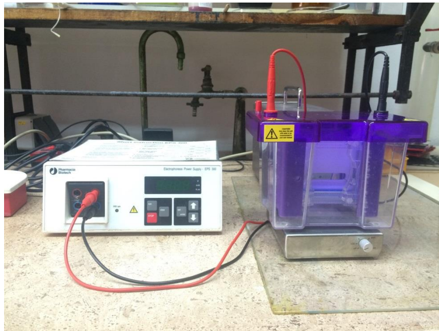
Slika 6. Sustav za vertikalnu gel elektroforezu SIGMA ALDRICH CVS10CBS omniPAGE mini dual (Sigma Aldrich, Milwaukee, SAD).
