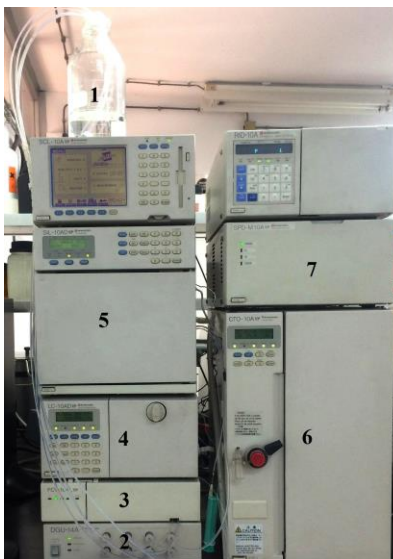
Slika 5. Kromatograf Shimadzu CLASS-VP LC-10A VP (Shimadzu; Kyoto, Japan). 1 - boca za pokretnu fazu; 2 - otplinjač; 3 - podjedinica za formiranje gradijenta; 4 - pumpa; 5 - auto-injektor; 6 - pećnica s predkolonom i kolonom; 7 - detektor.
