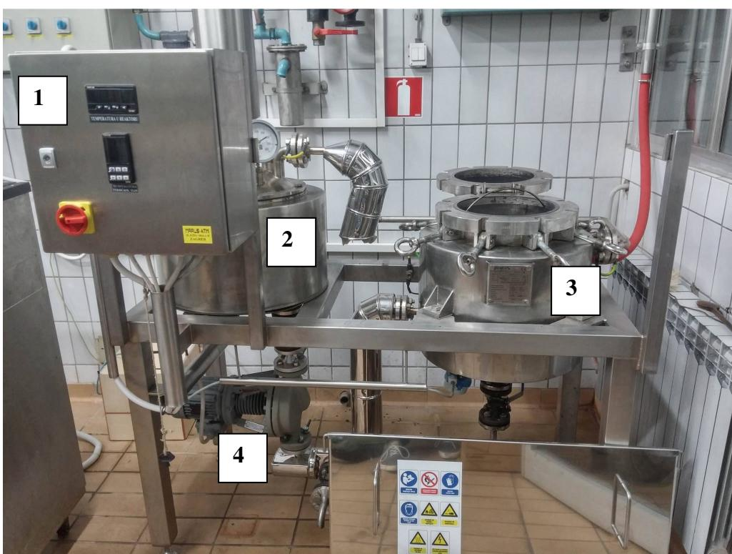
**Slika 7.** Visokotlačni reaktor ili uređaj za termičku predobradu lignocelulozne sirovine (1. kontrolna jedinica; 2. posuda sa termičkim uljem i grijaćima; 3. reaktor za predobradu sirovine; 4. pumpa).
