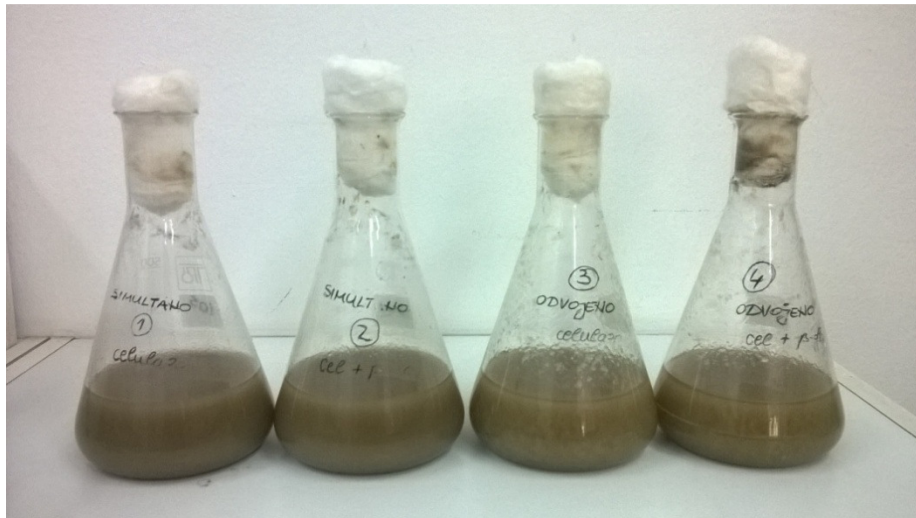
Slika 8. Prikaz podloga koje se sastoje od predobrađene pšenične slame (PS/180 °C/2 % NaOH/20 min) te kvašćevog ekstrakta i peptona.
