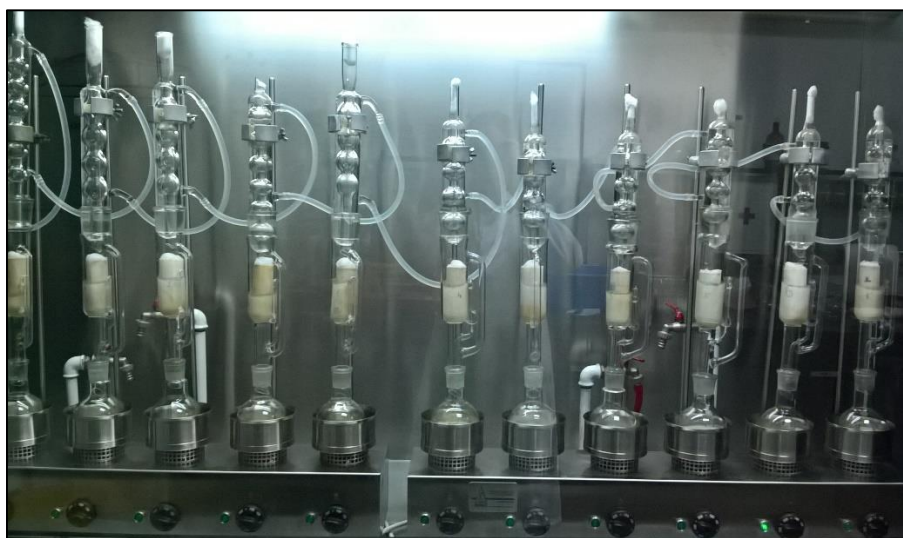
Slika 6. Aparatura po Soxhletu (vlastita fotografija)
