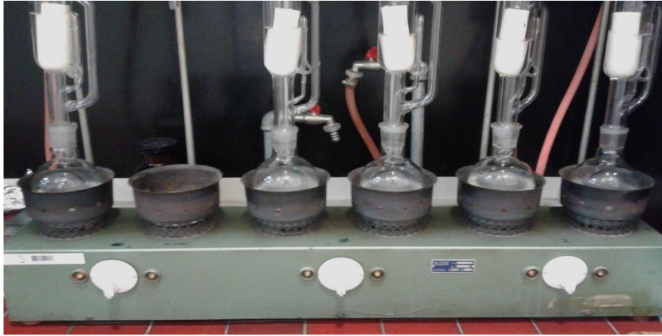
Slika 8. Određivanje masti po Soxhlet-u (vlastiti izvor)
