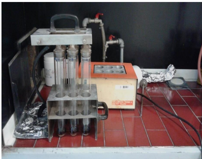
Slika 10. Mokro spaljivanje proteina u bloku za spaljivanje Tecator (vlastiti izvor)
