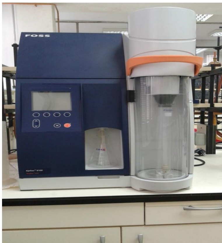
Slika 9. Uređaj za destilaciju proteina FOSS (Kjeltec 8100) (vlastiti izvor)
