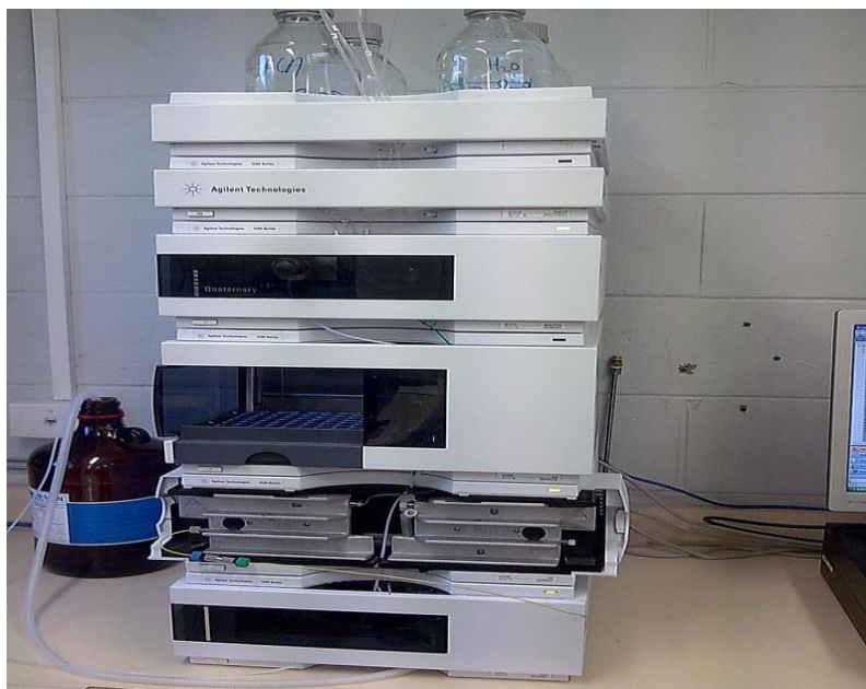
Slika 9. Tekućinski kromatograf Agilent 1200 series HPLC, Laboratorij za tehnologiju mesa i ribe Prehrambeno-biotehnološkog fakulteta
