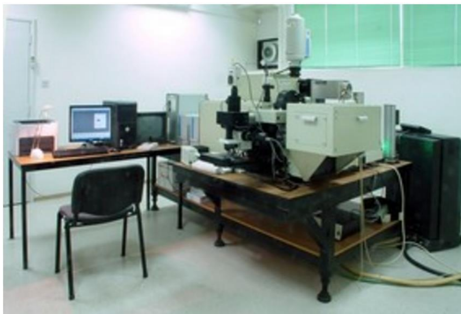
Slika 10. Horiba Jobin Yvon T64000 Ramanov spektrometar (Janči, 2016)
