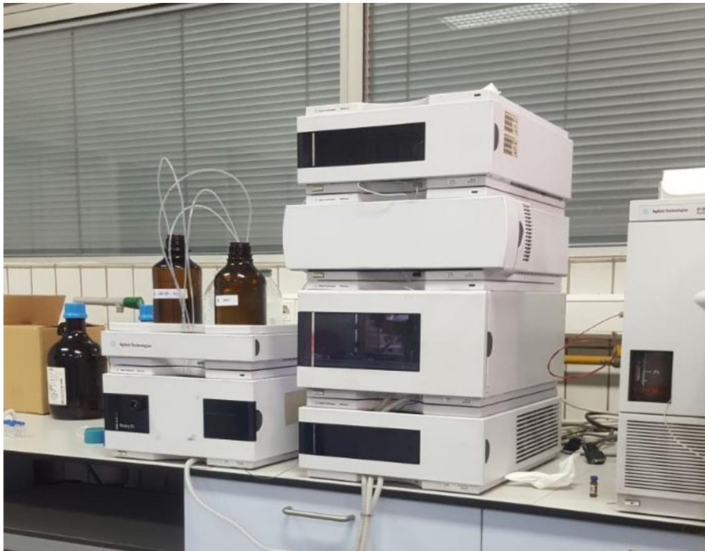
Slika 8. Tekućinski kromatograf Agilent 1200 series HPLC, Laboratorij za tehnologiju mesa i ribe Prehrambeno-biotehnološkog fakulteta (vlastita fotografija)
