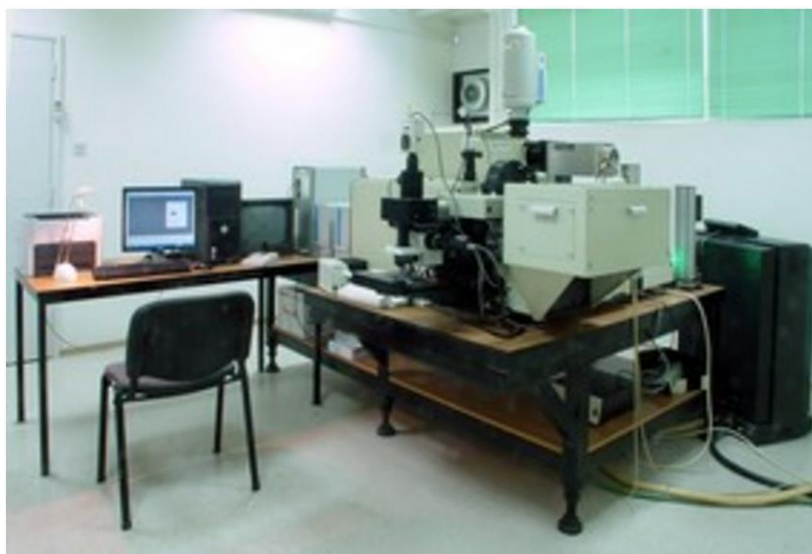
Slika 8. Horiba Jobin Yvon T64000 Ramanov spektrometar, Laboratorij za molekulska fiziku Instituta Ruđer Bošković
