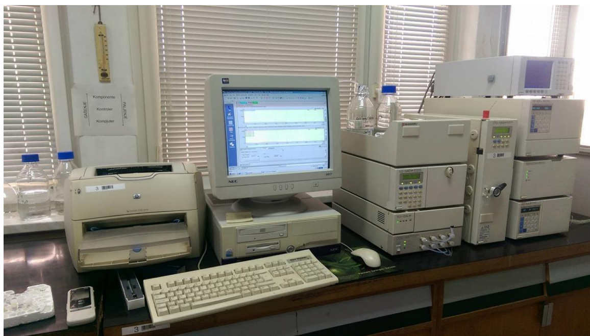
Slika 5. HPLC uređaj SHIMADZU (vlastita fotografija)
