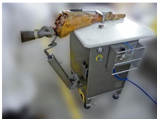
Slika 12. Uređaj za iskoštavanje pršuta (Cruells, 2017)
