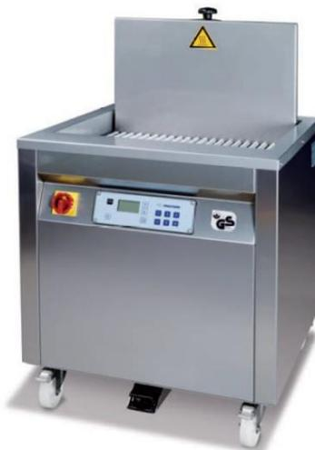
**Slika 14.** Tank za potapanje (Multivac 1, 2017)
