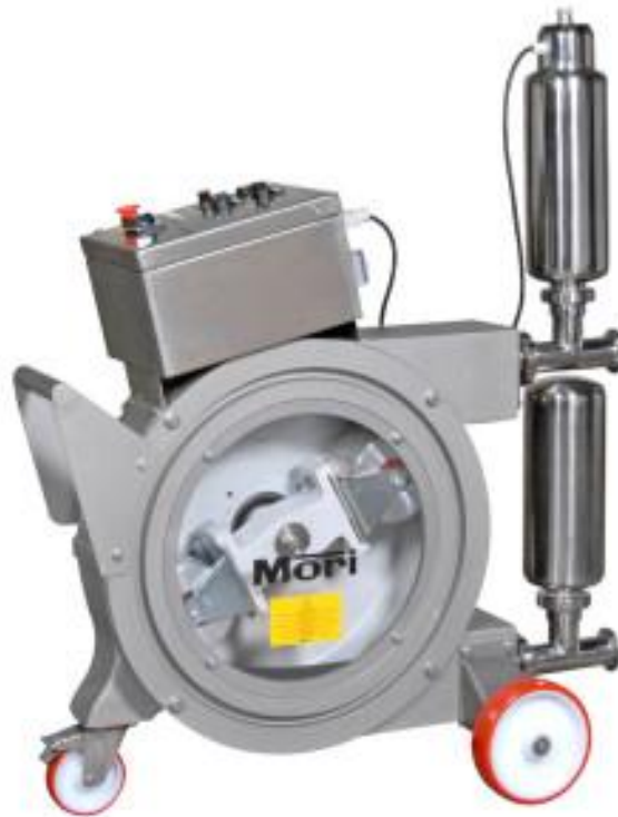
Slika 9. Peristalti ka pumpa (Pavin, 2016)
