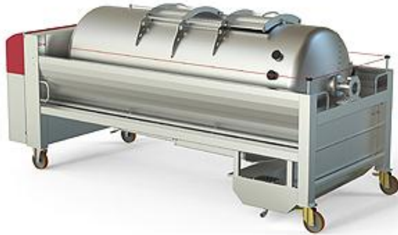
Slika 12. Pneumatska pre-a (Pavin 2,2016)
