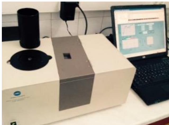
Slika 6. Kolorimetar (Spectrophotometer CH-3500 D, Konica Minolta, Engleska), (Vlastita fotografija)
