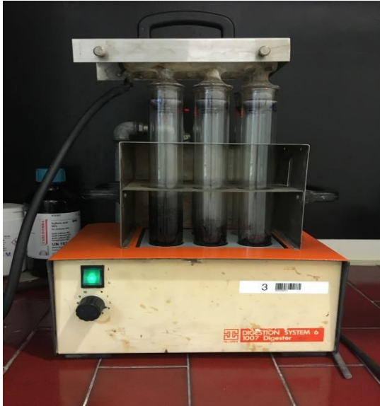
Slika 10. Blok za spaljivanje uzorka po Kjeldahl-ovom postupku (vlastita fotografija)
