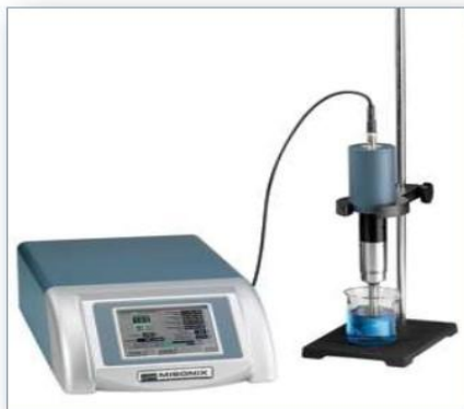
Slika 3. Ultrazvučni procesor model S-4000 (MisonixSonicators, Newtown, Connecticut, SAD)
