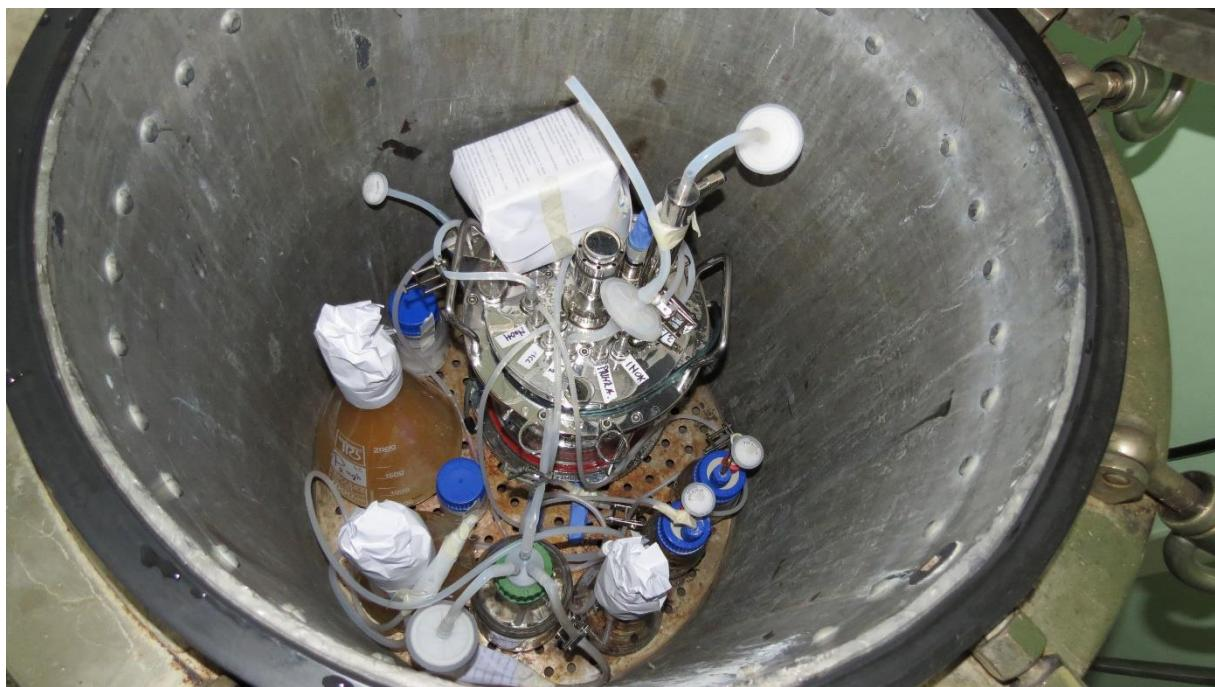
**Slika 8.** Dio *in vitro* sustava, posuda bioreaktora potrebnim priborom, u autoklavu prije sterilizacije.
