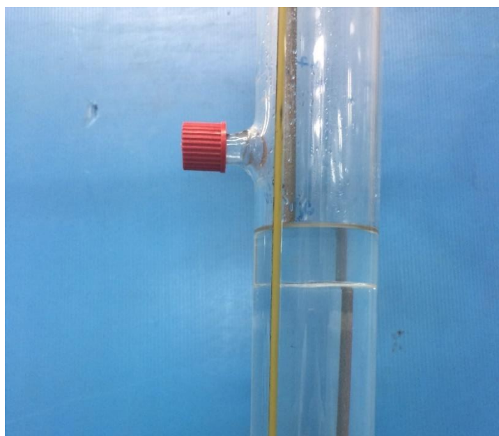
Slika 4.27. Razdvajanje faza u koloni za razdjeljivanje za ekstraktant oktan-1-ol. Primijenjen protok kroz kolonu iznosio je 0,98 L/h, srednja linearna brzina strujanja 1,51 \cdot 10^4 m/h, Re-broj strujanja kolone 1,98, primijenjen Re-broj miješala 4953,09.
